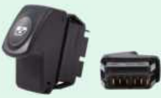
IM-2483 PULSADOR ELEVACIONES RENAULT PUERTA DEL. IZQ. 7700838101
